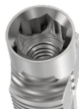
REX TL 2.9 Piattaforma serie: Ø 3,5 mm Esagono interno: 2,45 mm
