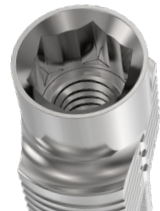
REX TL 2.9 Plattform Ø 3,5 mm Innensechskant: 2,45 mm
